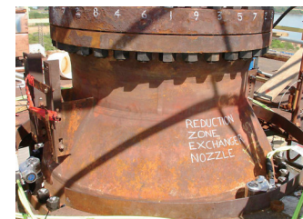
Mặt bích vòi phun của thiết bị trao đổi tải sinh dùng trong NM hóa dầu Kích cỡ bu lông 1-1/2", căng siết bằng hệ thống bốn bước đồng bộ AVANTI-3
