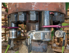
Kết hợp vòng đệm HYTORC tiến hành siết kéo căng dọc trục không bị lệch tải.
