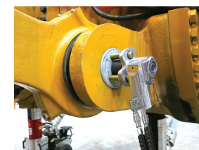
Kết hợp với công cụ đặc biệt, siết chặt kéo căng dọc trục không cần phản lực
